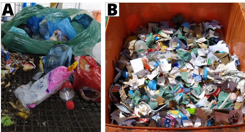
Figura 02: Amostragem e preenchimento das células experimentais de RDO. A: amostras de RDO; B: RDO dispostos nas células experimentais após análise gravimétrica e trituração manual ( \varnothing < 80 mm).
